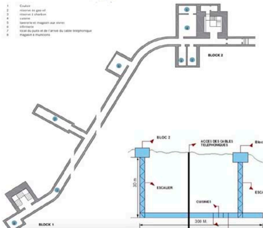
➤ Plan sommaire des souterrains - Galerie souterraine reliant le bloc 1 (à droite) et le bloc 2 (à gauche)
