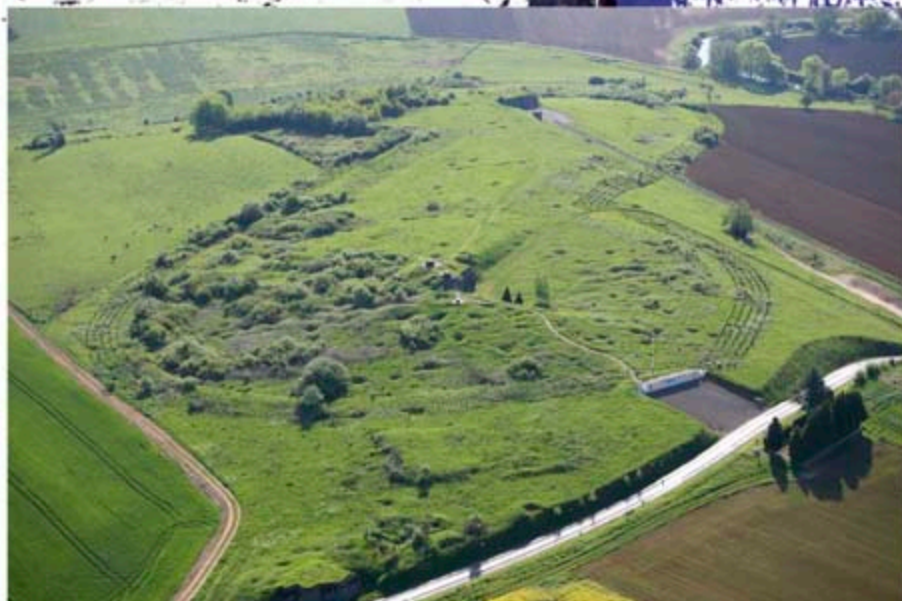
↗ Vue aérienne des dessus de l'ouvrage. Le bloc 2 est visible au centre de l'image et le bloc 1 un peu plus haut. On reconnaît également le réseau de barbelés et de rails antichar tout autour du fort.
