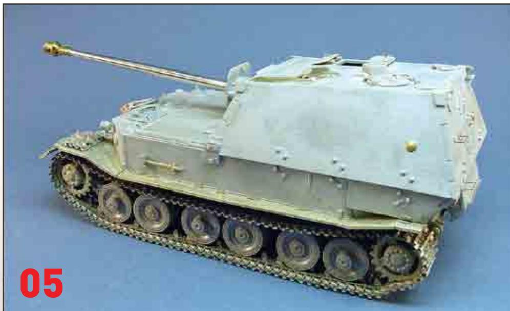
L'avant verra lui aussi son lot de pièces laiton rapporté. Les fixations des patins de recharge sont du type standard provenant du montage en usine. Le set Aber propose plusieurs variantes issues de modifications effectuées sur le terrain mais qui semblent avoir été réalisées après Koursk. Les fixations de la calle et du cric de 20 tonnes, issus de la planche Aber, sont mises en place. Bien qu'ayant refait le cric et sa calle entière-
