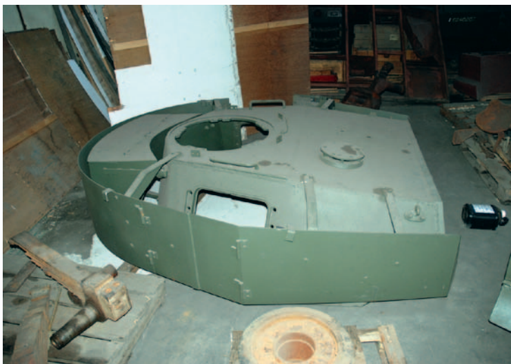
➤ La tourelle est repeinte avec une teinte anti rouille verte. Les « schürzen » ont été totalement refabriqués.
