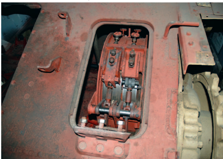
➤ Le système de frein de direction a été révisé et a retrouvé sa place.
