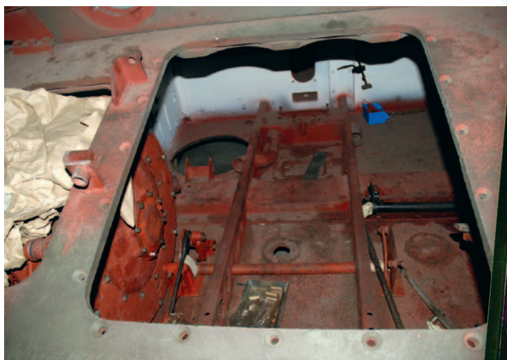
➤ L'emplacement du bloc transmission qui est en cours de restauration.
